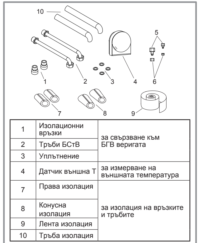
Фиг.4 Аксесоари доставяни с хидравличния модул
